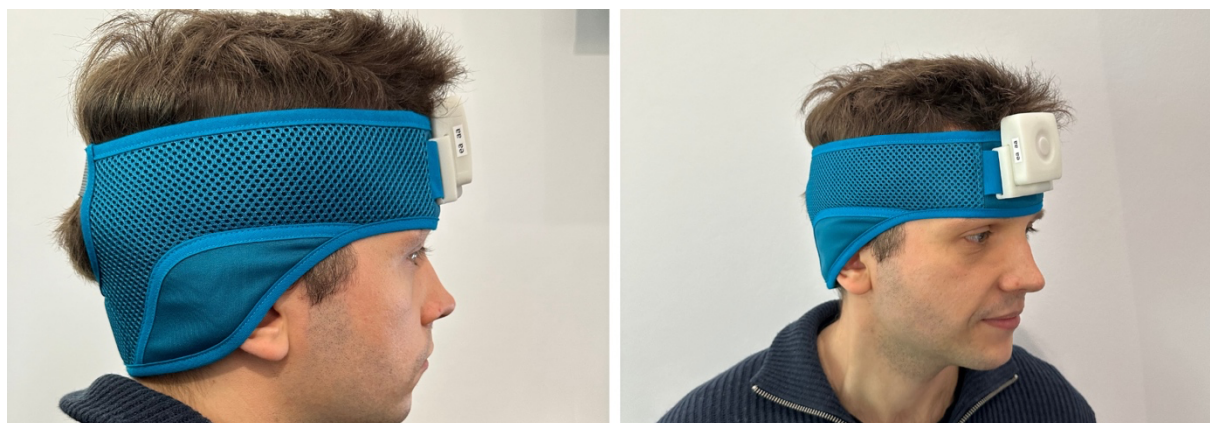
Rys. 15. Umiejscowienie Opaski ze Stymulatorem na głowie
