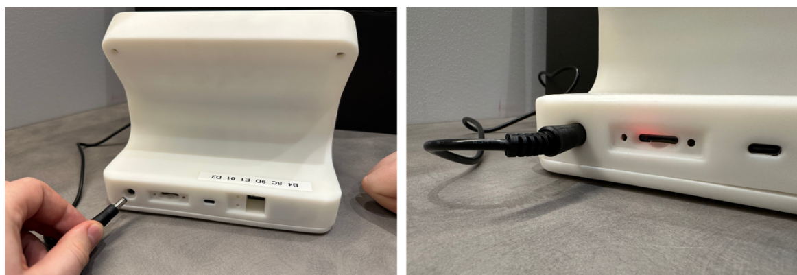
Rys. 9. Podłączenie zasilania do Stacji bazowej
