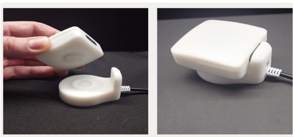
Rys. 12. Poprawna pozycja stymulatora na ładowarce
