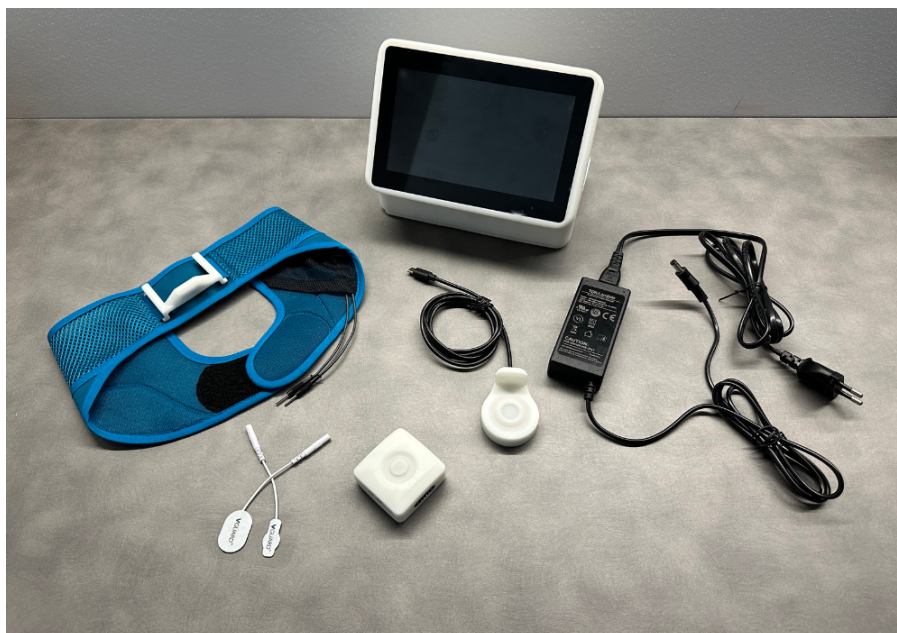
Rys. 1. System VGuard (od lewej) - 1. Opaska, 2. Elektrody, 3. Stymulator, 4. Stacja bazowa, 5. Ładowarka, 6. Zasilacz
